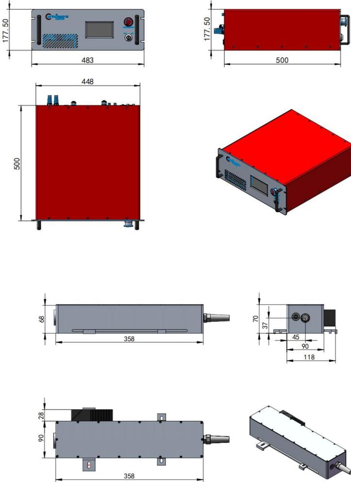
水冷激光器尺寸图 (输出功率 > 10W)
